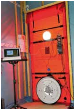
Blower door test Source photographe : Eric Legret
